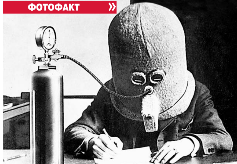
«Изолятор» - так назвали изобретение, запатентованное в США в 1925 г. Звукоизолированный шлем с подключённым к нему баллоном с кислородом надёжно изолировал учёного от внешних шумов, что позволяло ему эффективно сосредоточиться на умственной работе. Может, американские учёные пользуются этим изобретением до сих пор, поэтому у них так много нобелевских лауреатов?
