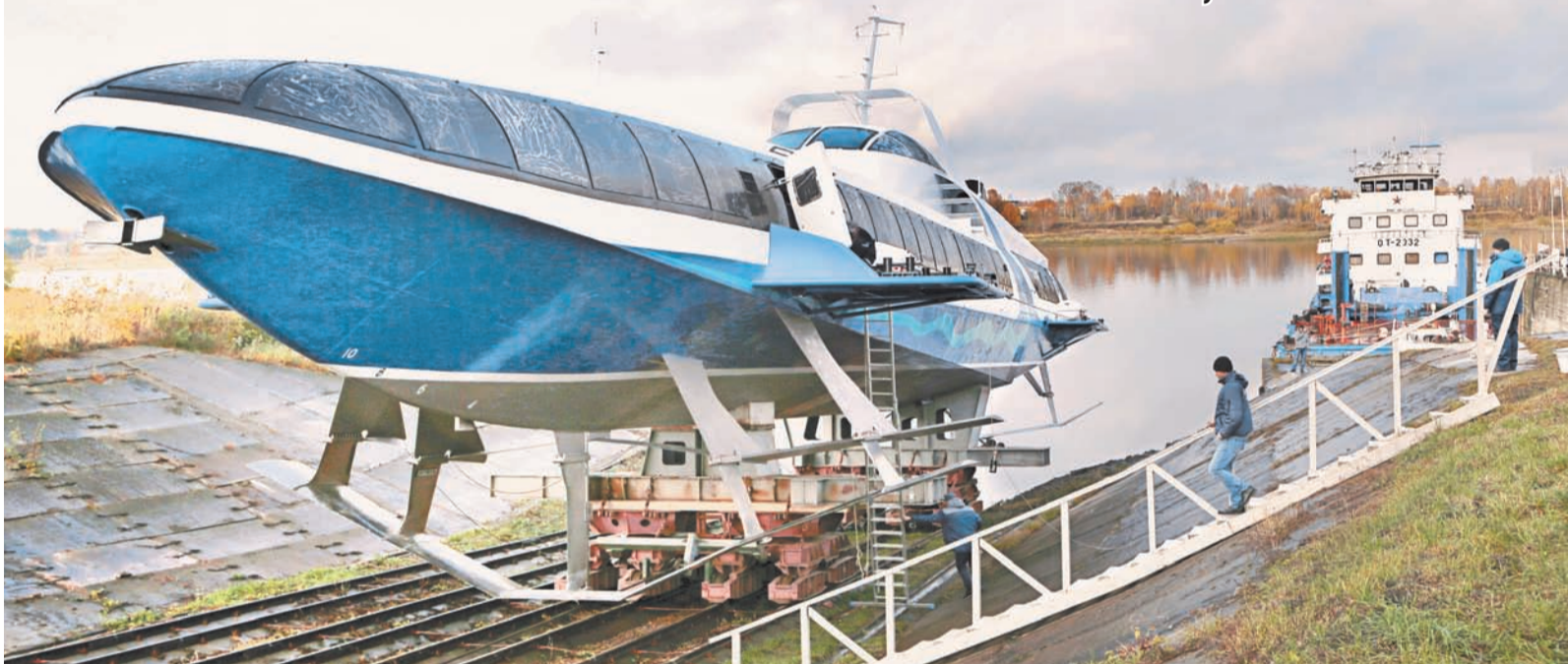
На судостроительном заводе «Вымпел» в г. Рыбинске спустили на воду новое скоростное пассажирское судно на подводных крыльях «Комета 120М». Судно рассчитано на 120 пассажиров и начнёт курсировать по маршруту Севастополь - Ялта с 2018 г. «Комета» развивает скорость до 35 узлов (почти 65 км/ч), то есть маршрутное время между двумя городами составит 1,5 часа (на междугороднем автобусе - 2 часа, если без пробок). На Чёрное море планируют поставить 20 таких судов.
