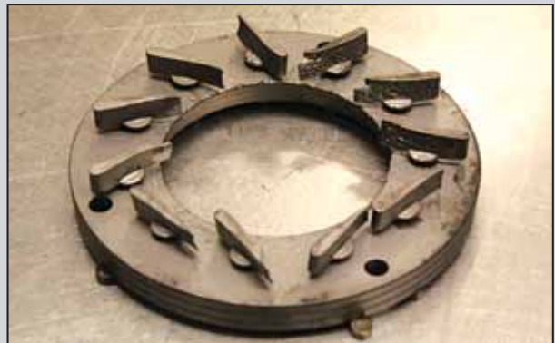
Повреждения от посторонних предметов видны на механизме переменной геометрии. Затвердевшие частицы внутри выхлопной системы непрерывно будут ударяться о направляющие лопасти, вызывая образование канавок.
