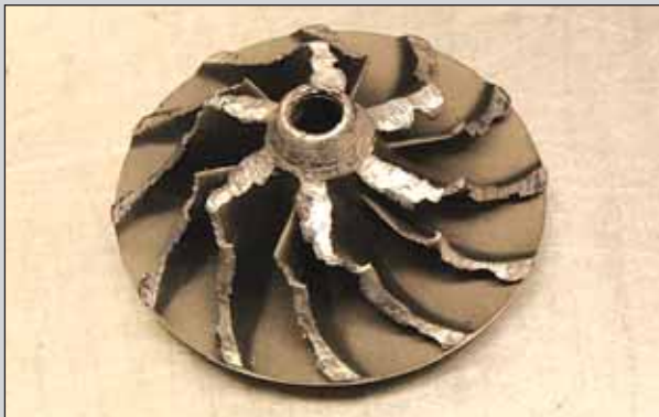
Повреждение колеса компрессора от посторонних предметов. Лопасти неоднократно подвергались ударам. Корпус компрессора тоже имеет признаки попадания посторонних предметов.
