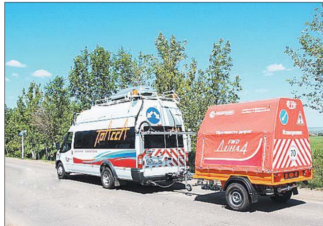
Дорожная лаборатория предназначена для диагностики состояния автомобильных дорог.
