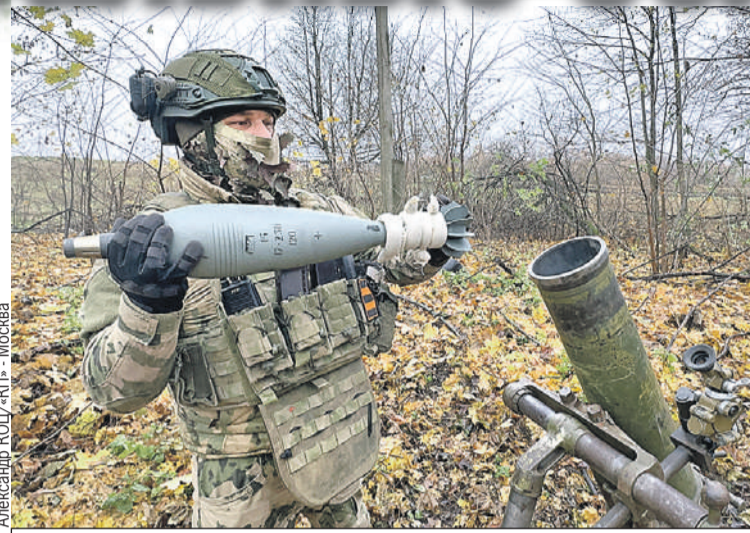
Каждый из пучков, накрученных на хвостовик мины, дает километр дальности.
