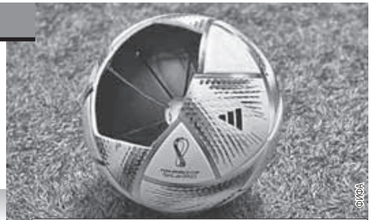
В центре сферы расположен датчик, который показывает не только положение мяча на поле, но и силу удара по нему.
