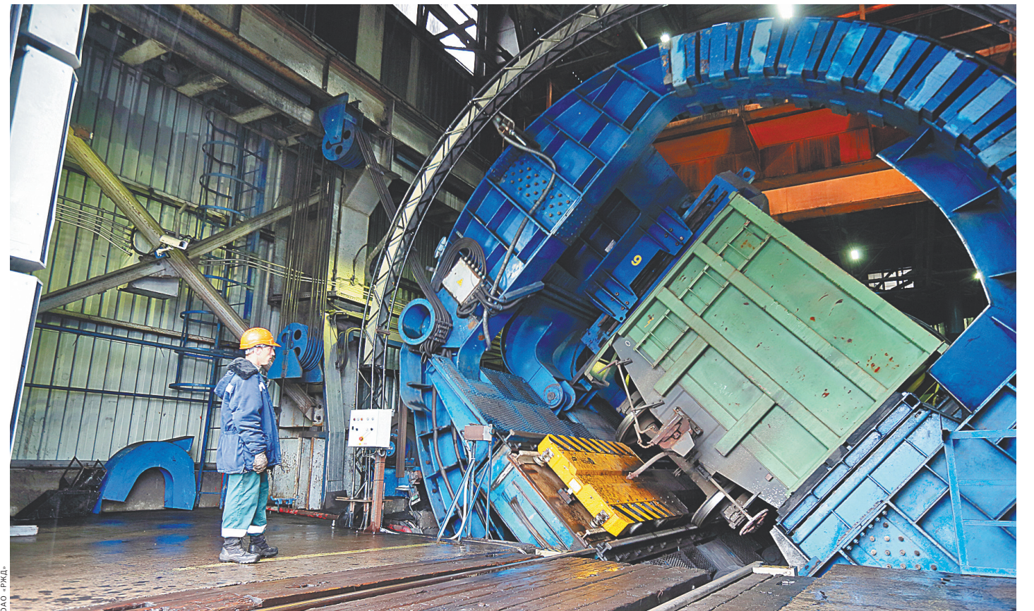
Наличие вагоноопрокидывателей на угольных терминалах портов позволяет переваливать на суда до 30 вагонов в час.
