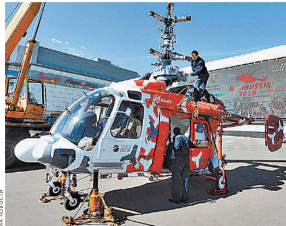
Корабельная версия Ка-226Т отличается не только складывающимися лопастями, но и адаптацией к работе в море.
