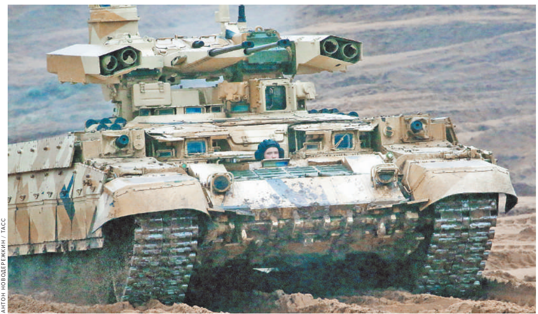
БМПТ «Терминатор-2» сильно не только управляемыми ракетами, но и спаренными 30 мм пушками 2А42.
