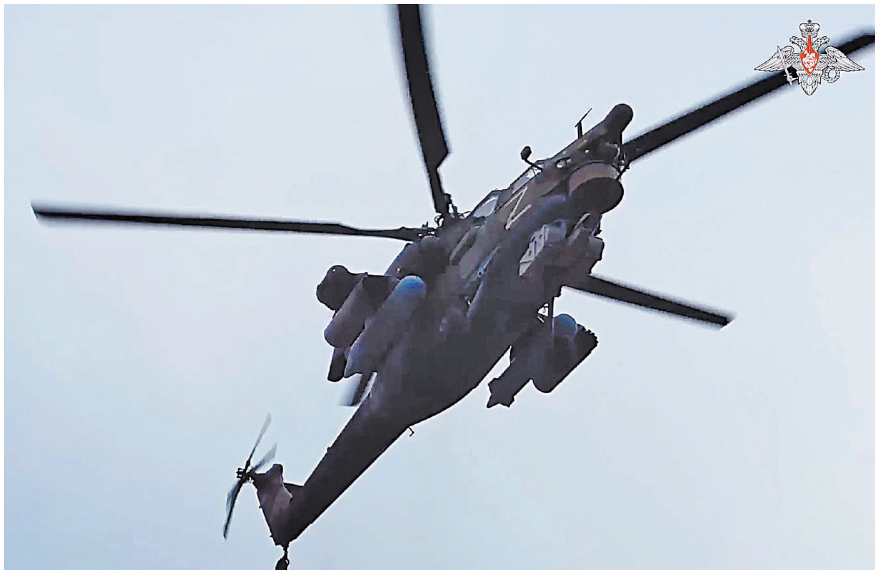
Стандартный арсенал Ми-28Н «Ночной охотник» — 30-мм скорострельная пушка и четыре блока ракет, по два с каждого борта. В боевых вылетах чаще используют боеприпасы большого калибра.
