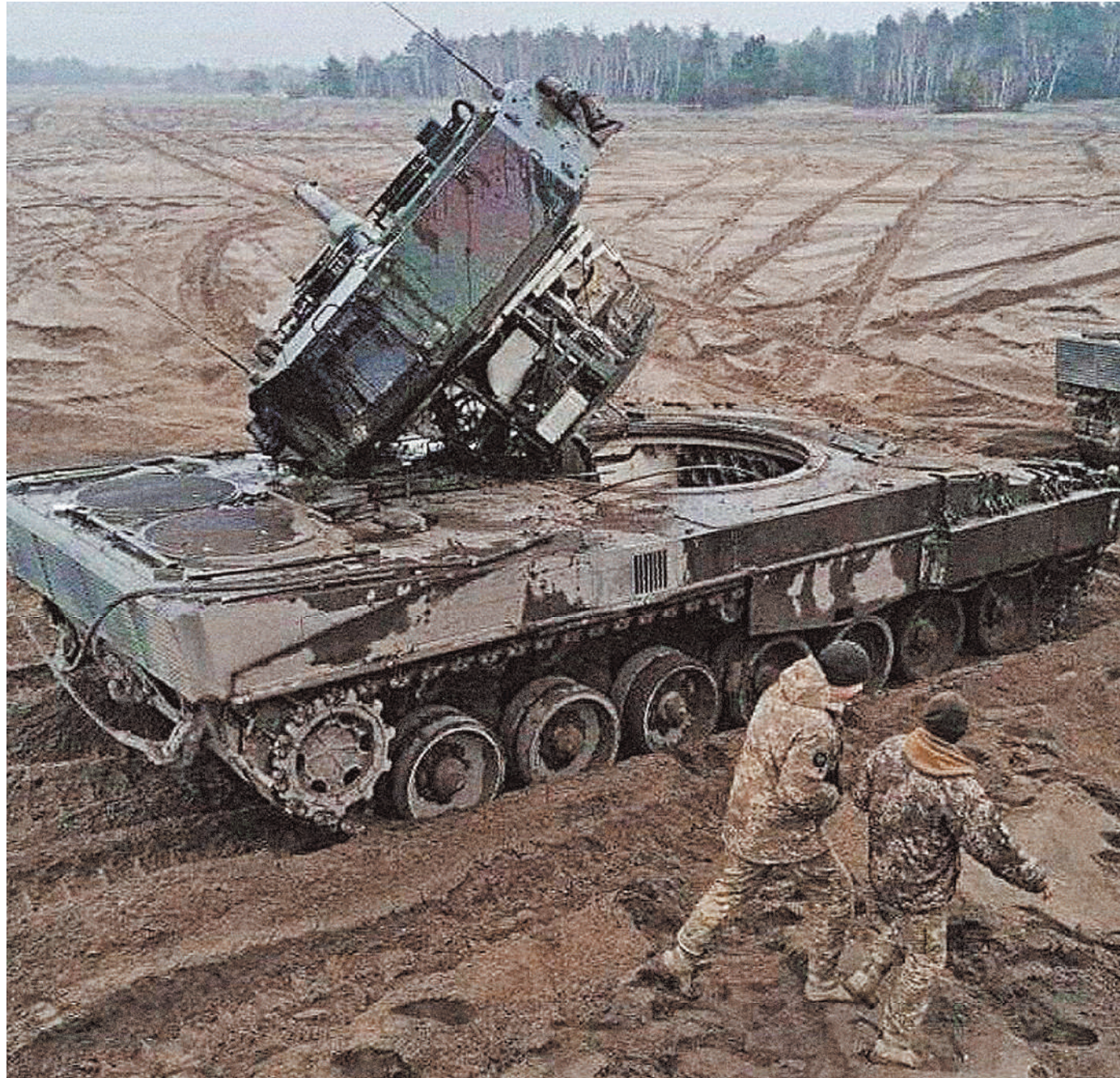
Этот Leopard до Украины не доехал — служащие ВСУ во время тренировок на полигоне в Польше, предположительно, снесли его башню, протаранив ее другим танком.
