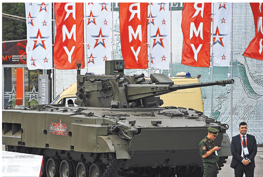
БМП-3 с модулем «Байкал», оснащенным 57-мм автоматической пушкой, на одном из форумов «Армия».
