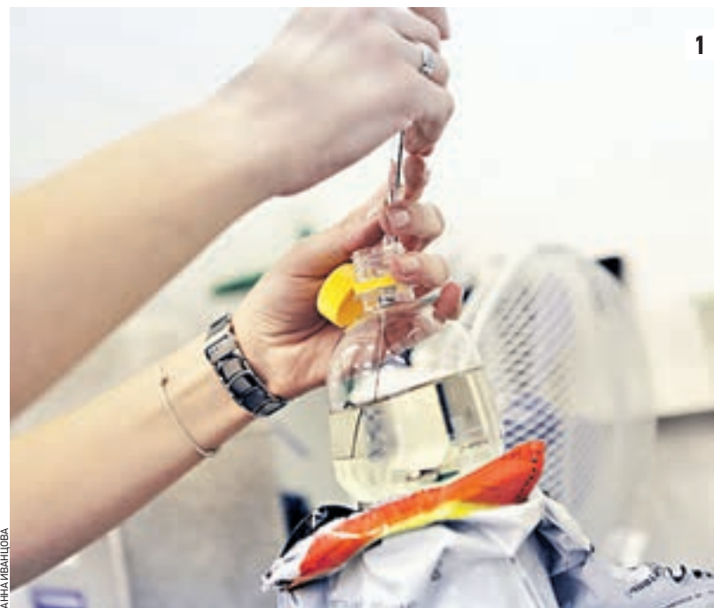
Вчера 10:32 Проба топлива хранится в закорюченном пакете, чтобы обеспечить анализу анонимность и объективность. Для проверки углеводород забирается шприцем (1) 10:36 Инженер-лаборант аналитической инспекции Елена Липай готовит лабораторию к работе над пробой бензина (2)
