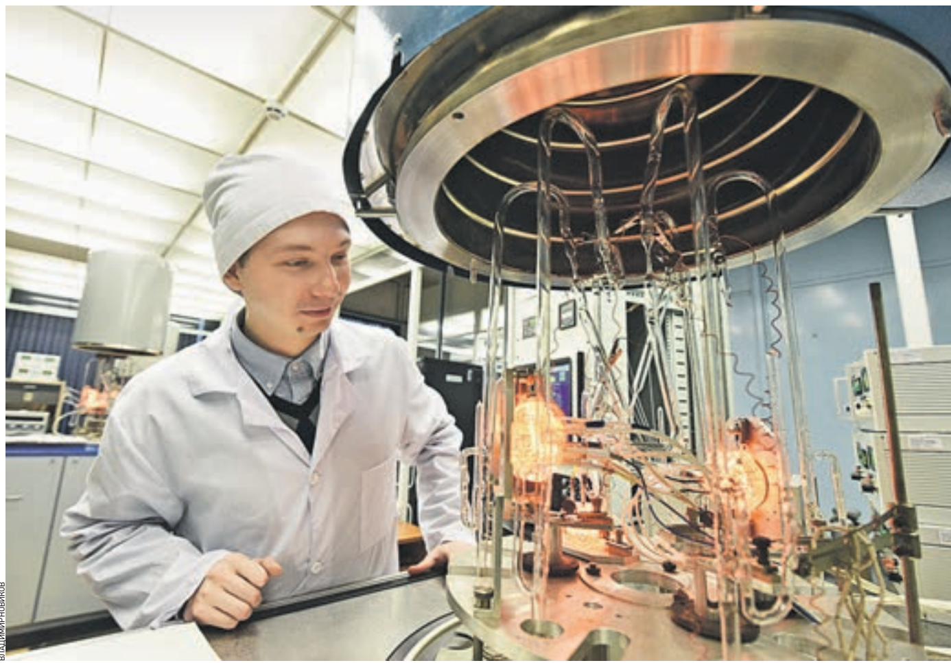
27 октября 10:12 Владимир Котов, начальник участка термовакuumной обработки одной из лабораторий Научно-исследовательского института «Полюс» имени Стелмаха, готовит датчики, на основании которых будут созданы сверхточные лазерные гироскопы
