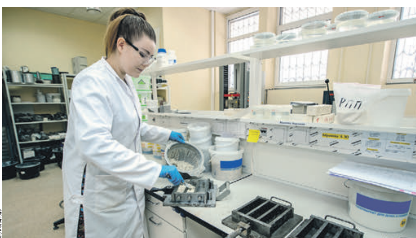
3 февраля 2016 года 13:25 В лаборатории строительных композитов, растворов и бетонов Анастасия Абрамова готовит к испытаниям декоративную штукатурку «Короледа». Фабричные производства дорожат качеством своей продукции, а другие, бывает, химичат
