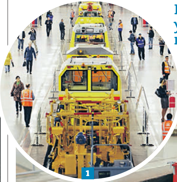
▶ На выставке хозяйственных поездов — машинизированный ипотечный комплекс Службы пути с шурупвертом и гайковертом (1) и мотовоз серии ДМ (2)
