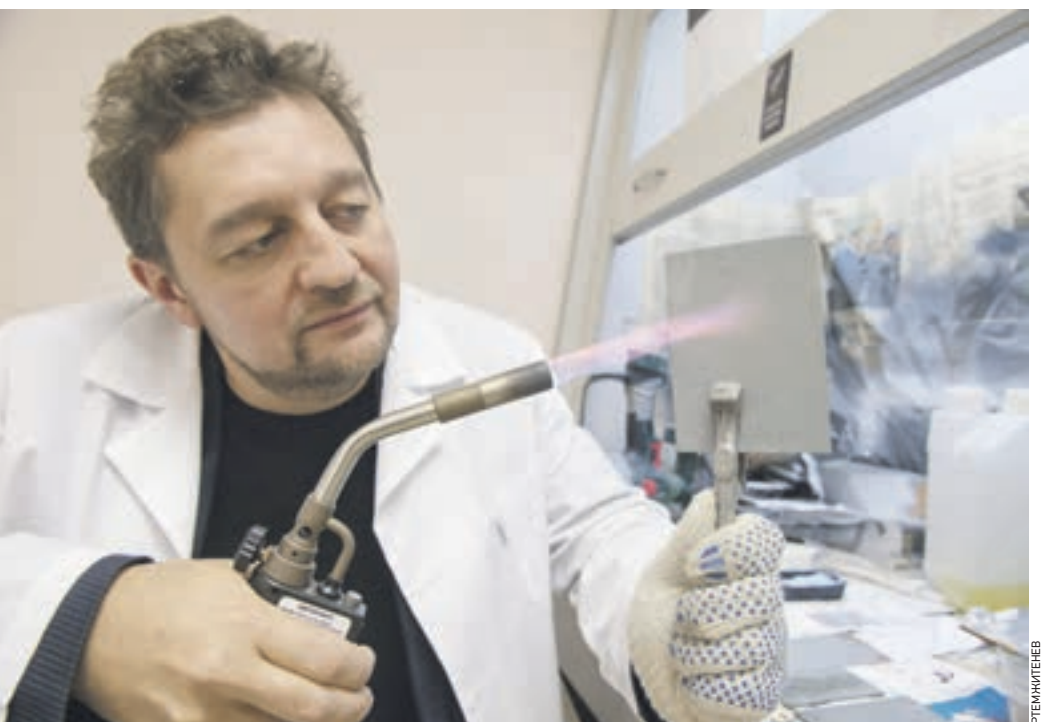
Вчера 12:40 Гендиректор компании, разработавшей уникальное покрытие для защиты металлических конструкций от ржавчины, Александр Михайлов тестирует его в лаборатории с помощью горелки
